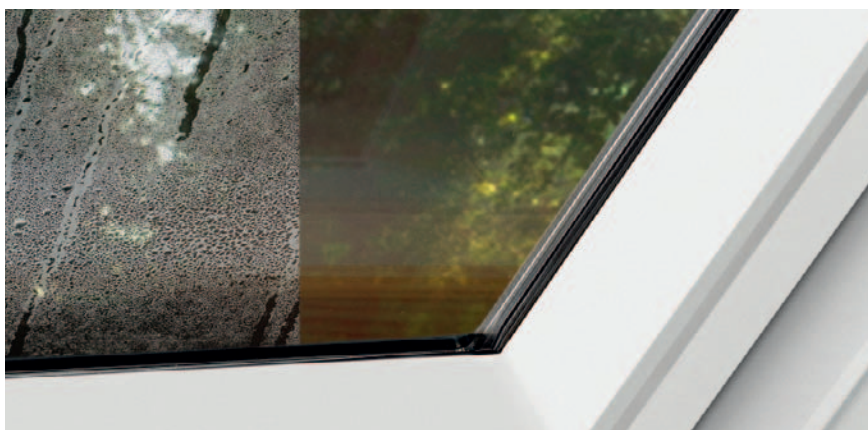
Bal oldali üveg harmatmentesítő hatás nélkül, jobb oldali üveg harmatmentes bevonattal
